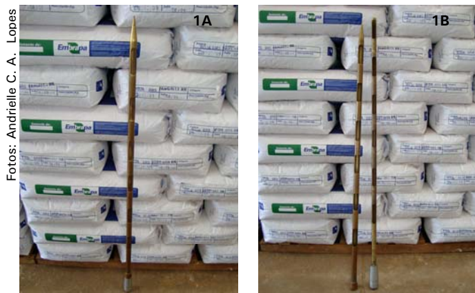
Fig. 1. Amostradores de sementes. A. Amostrador do tipo simples e B. Amostrador do tipo duplo.
